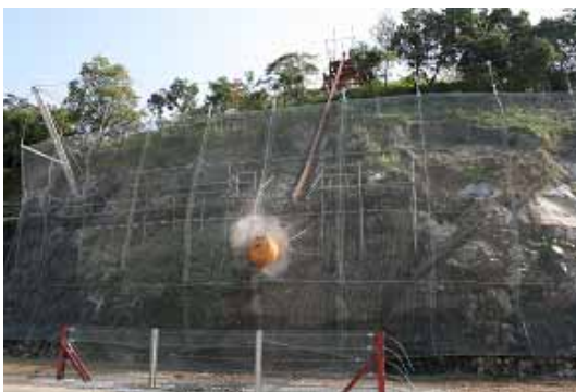
写真4 第9回目の実験(重錘2.1t, 400kJ)
