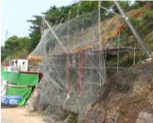
写真2 第1回目の実験(重錘0.5t, 70kJ)
